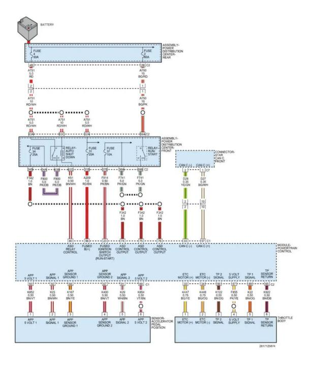
P050B wiring diagram
