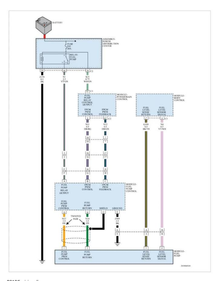
P018C wiring diagram
